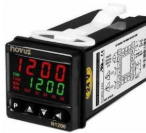
Figura 7 – Dispositivo de controle e coleta de dados de temperatura Nivus N1200
