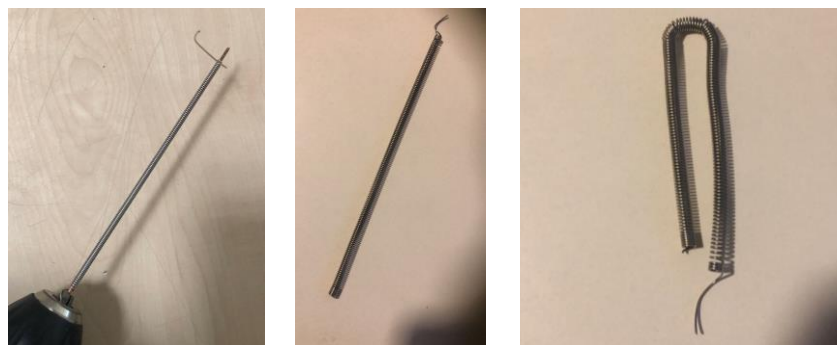
Figura 9 – Fabricação da resistência de aquecimento do corpo de prova.
