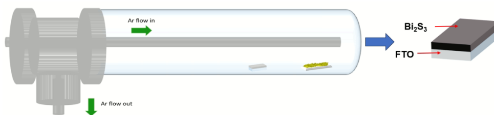
Figura 14 – Esquemático do tubo de quartzo com o mecanismo de fluxo de argônio para a sulfuração.
