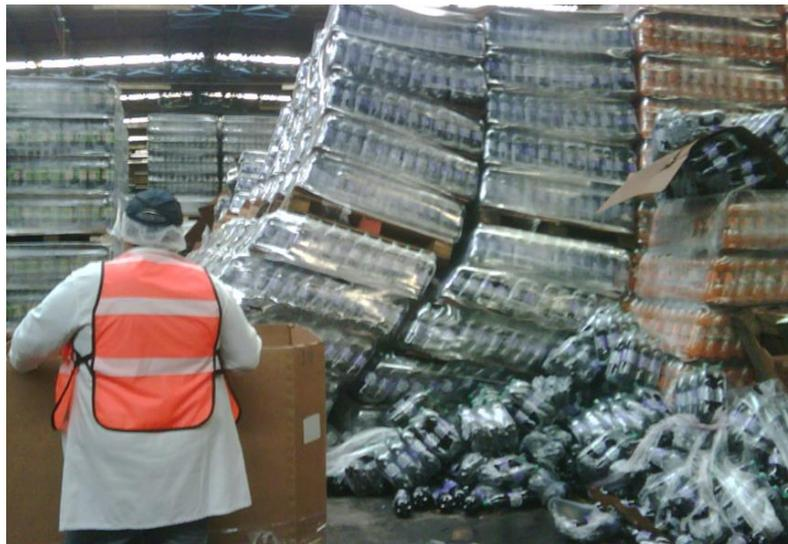
Figura 5: Representação de falha no armazenamento de cargas por falha na unitização. [10,13]
