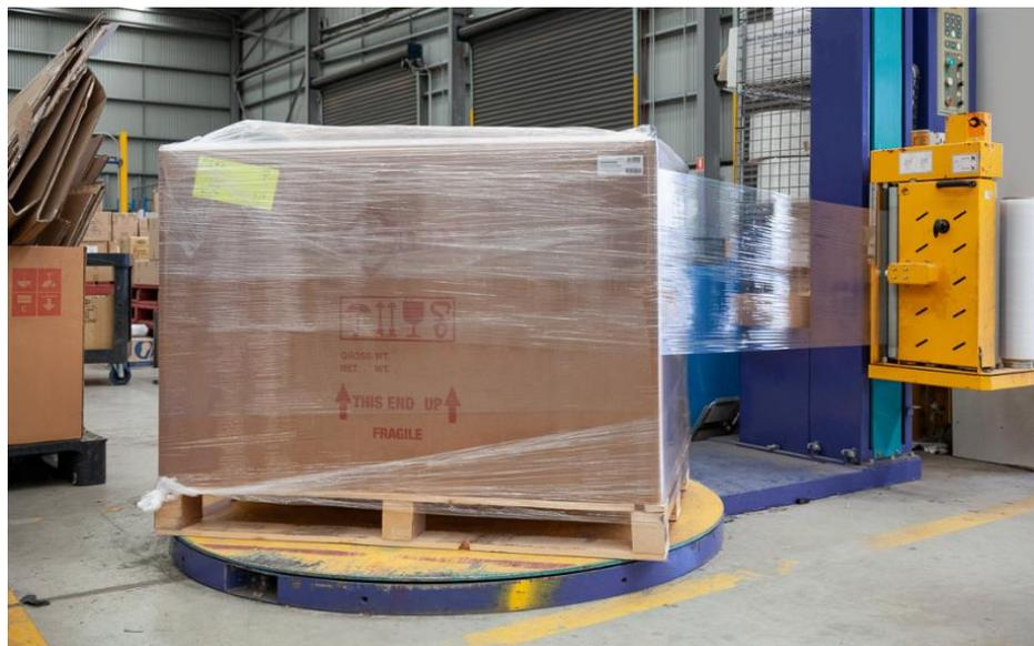
Figura 4: Máquina automática envolvedora de cargas com filme *Stretch Wrap*. [12]
