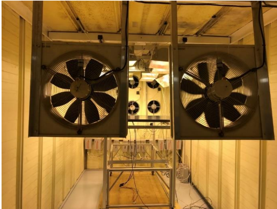
Figura 5.15 – Imagem do interior do simulador, com destaque para os ventiladores de convecção forçada.
