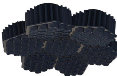
Figura 4.6 – Desenho do arranjo de LEDs proposto pelo trabalho de Tavakoli et al., (2021).
