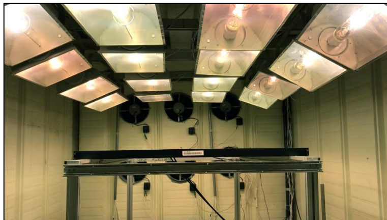
Figura 5.10 – Imagem do novo simulador solar com as 16 lâmpadas em operação.
