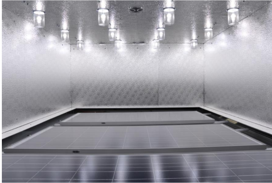
Figura 4.10 – Area interna de simulador comercial com lâmpadas de plasma, em operação (Solaronix, 2023).
