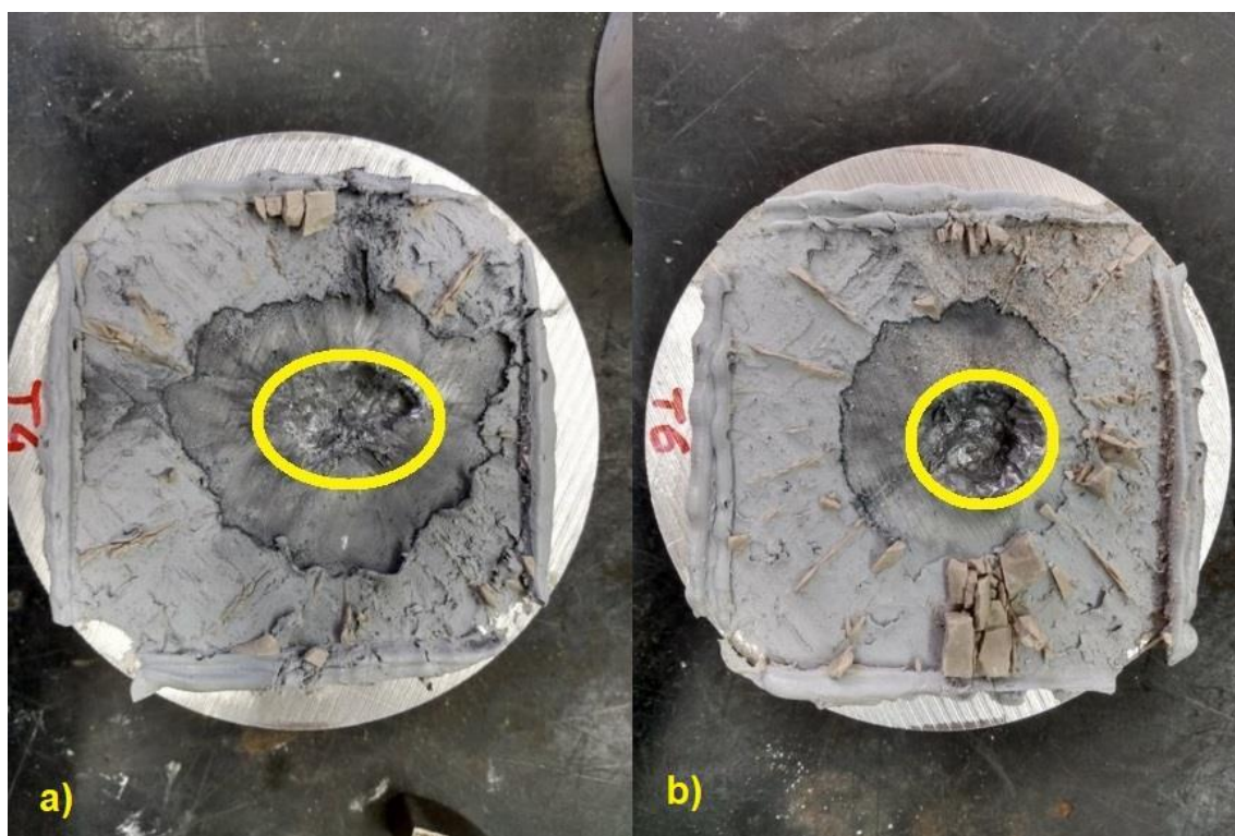
Figura 5.11. Formato da cratera deixada na placa de apoio, após ensaio DOP em porcelanato de referência (AP0Q): a) formato oval que indica colisão lateral (AP0Q1); b) formato circular (AP0Q3).
