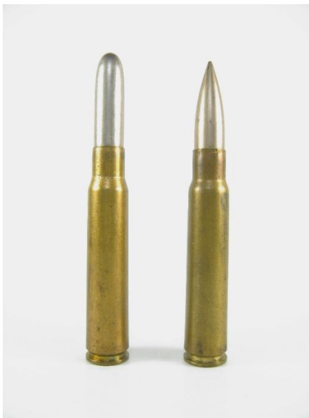
Figura 3.9. Imagem comparativa de duas munições de mesmo calibre, na esquerda com projétil de ponta redonda e na direita com projétil Spitzer (“Spitzer bullet”, 2022).
