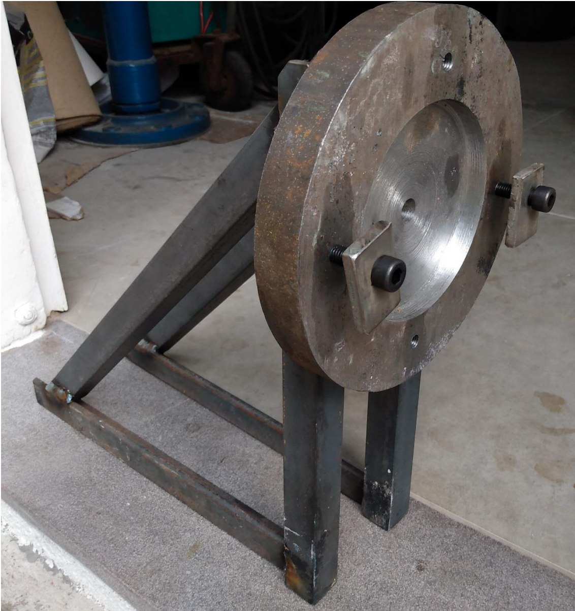
Figura 4.8. Suporte confeccionado para fixar os corpos de prova e garantir o alinhamento no ensaio de DOP.
