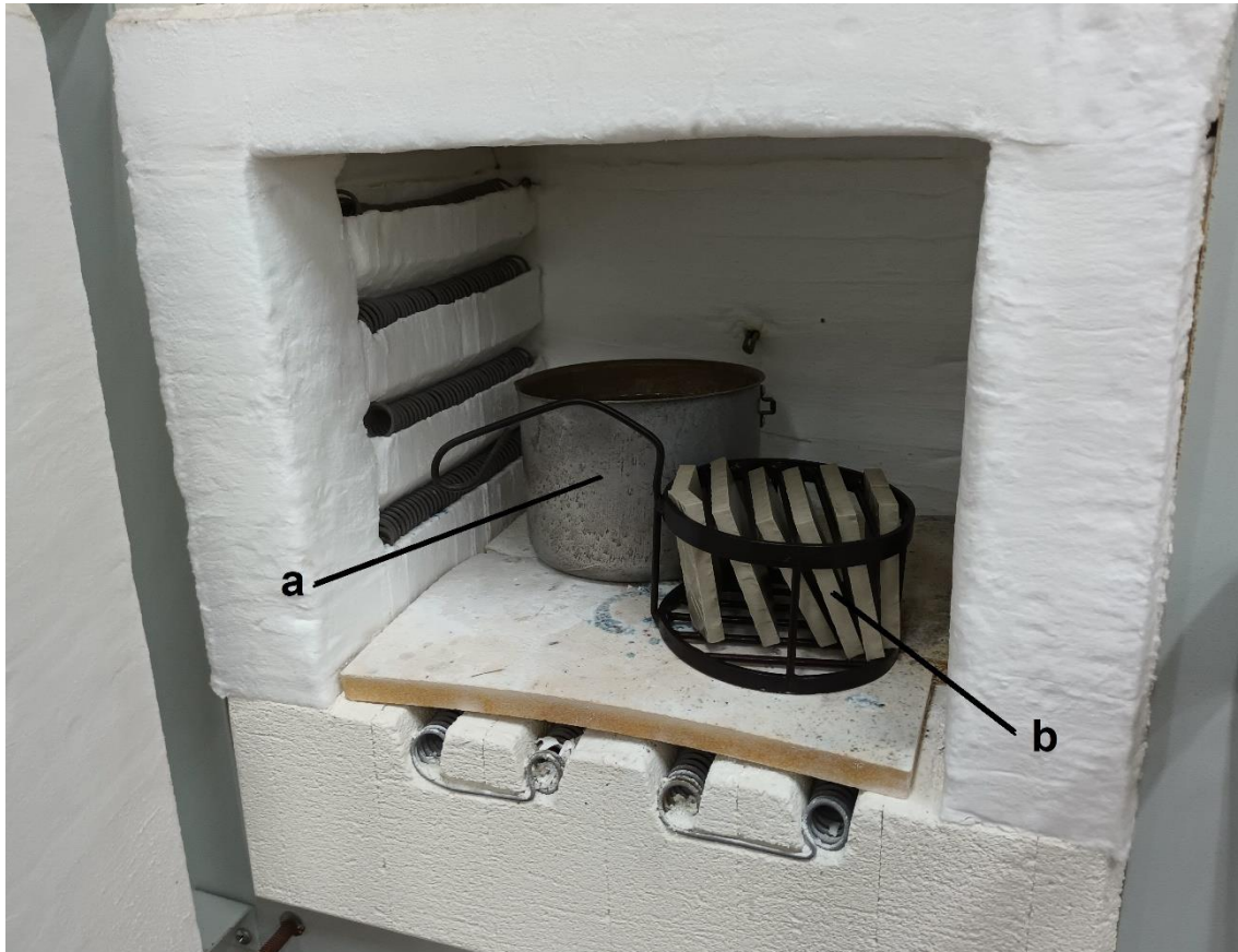
Figura 4.5. Forno usado na têmpera química e acessórios: a) recipiente com o nitrato de potássio fundido; b) suporte com o porcelanato no pré-aquecimento.
