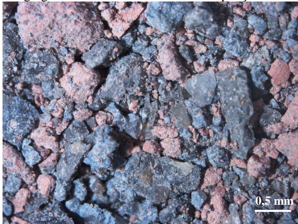
Figura 18 – Fotografia com lupa estereoscópica do agregado miúdo reciclado AR1 – Ampliação 10x
