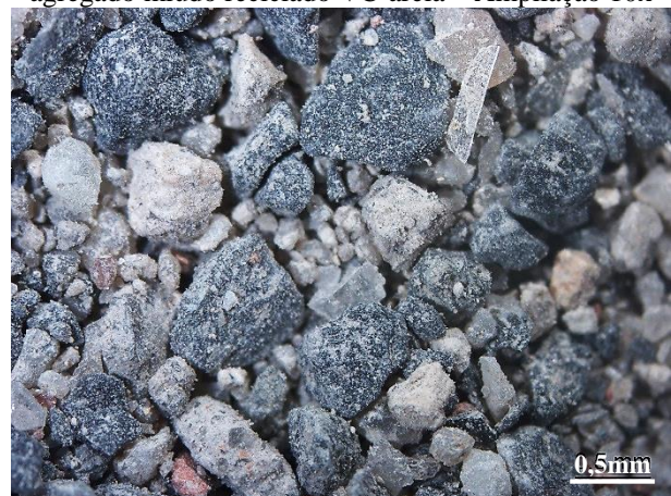
Figura 17 – Fotografia com lupa estereoscópica do agregado miúdo reciclado VC-areia – Ampliação 10x
