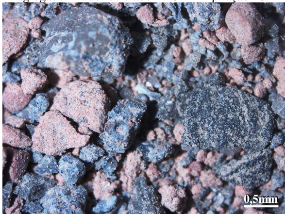
Figura 20 – Fotografia com lupa estereoscópica do agregado miúdo reciclado AR3 – Ampliação 10x
