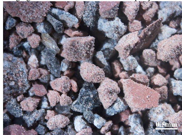
Figura 25 – Fotografia com lupa estereoscópica do agregado miúdo reciclado AR8 – Ampliação 10x
