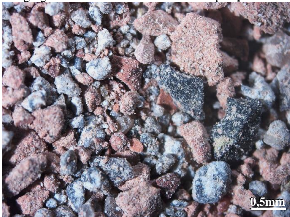
Figura 22 – Fotografia com lupa estereoscópica do agregado miúdo reciclado AR5 – Ampliação 10x
