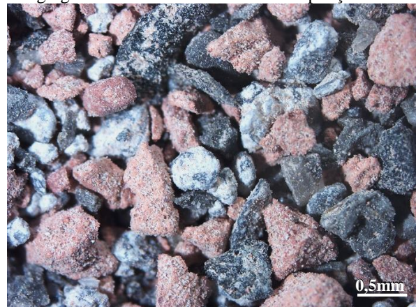
Figura 23 – Fotografia com lupa estereoscópica do agregado miúdo reciclado AR6 – Ampliação 10x
