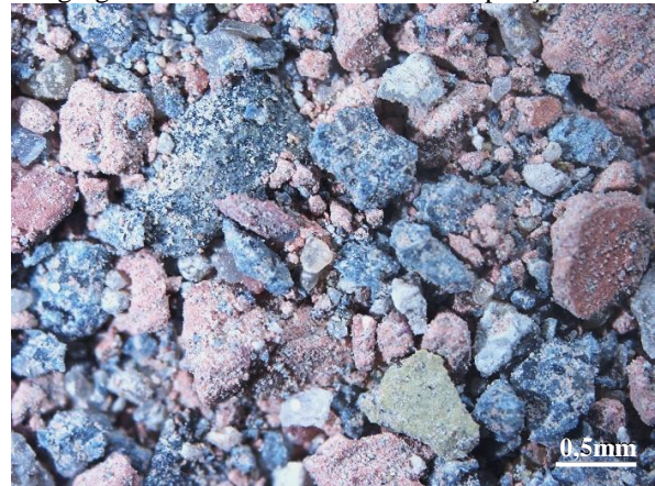
Figura 19 – Fotografia com lupa estereoscópica do agregado miúdo reciclado AR2 – Ampliação 10x
