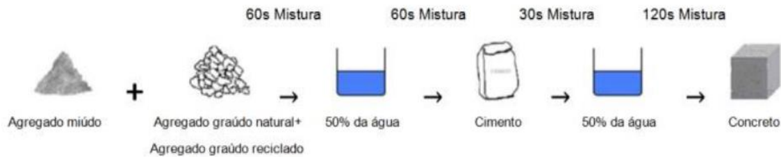
Figura 3 – Método de mistura em dois estágios (TSMA)
