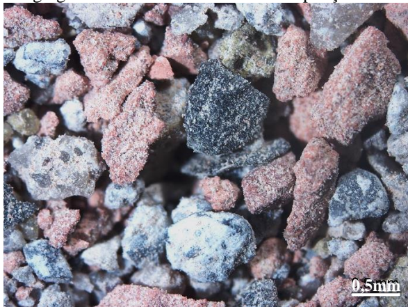
Figura 24 – Fotografia com lupa estereoscópica do agregado miúdo reciclado AR7 – Ampliação 10x
