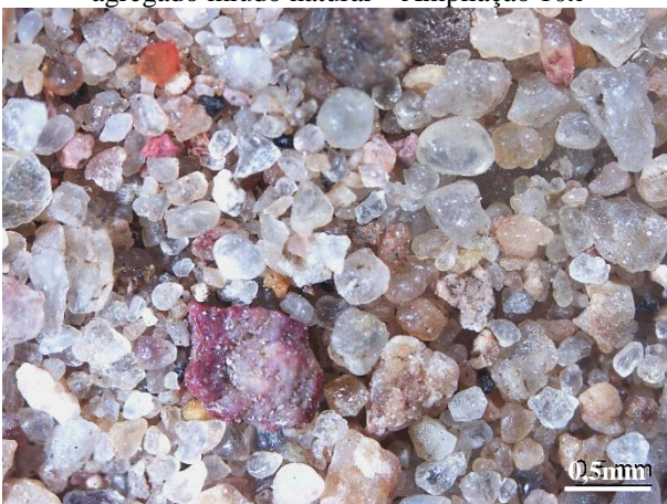
Figura 16 – Fotografia com lupa estereoscópica do agregado miúdo natural – Ampliação 10x
