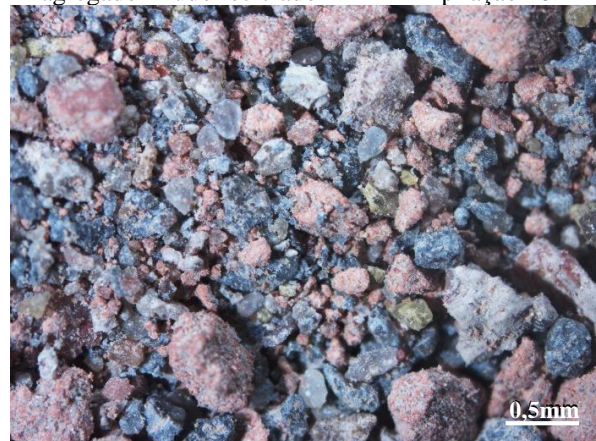
Figura 21 – Fotografia com lupa estereoscópica do agregado miúdo reciclado AR4 – Ampliação 10x
