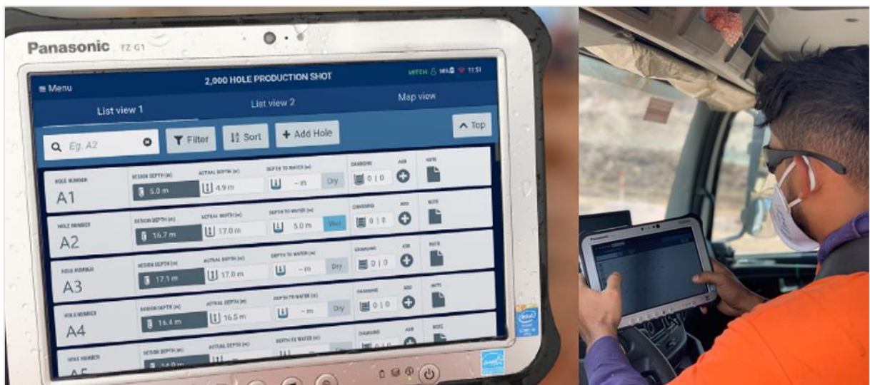
Figura 18 - Tablet usado para cadastro digital de dados do carregamento com explosivos.
