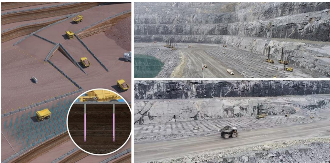
Figura 5 - Aplicação de detonadores sem fio na flexibilização da operação de mina à céu aberto.
