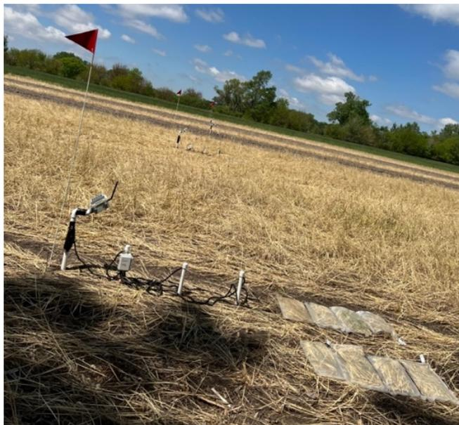
**Figura 4.** Instalação dos sensores de umidade e temperatura do solo e deposição dos *litterbags* logo após a semeadura do milho em uma fazenda em Nebraska, Estados Unidos da América.
