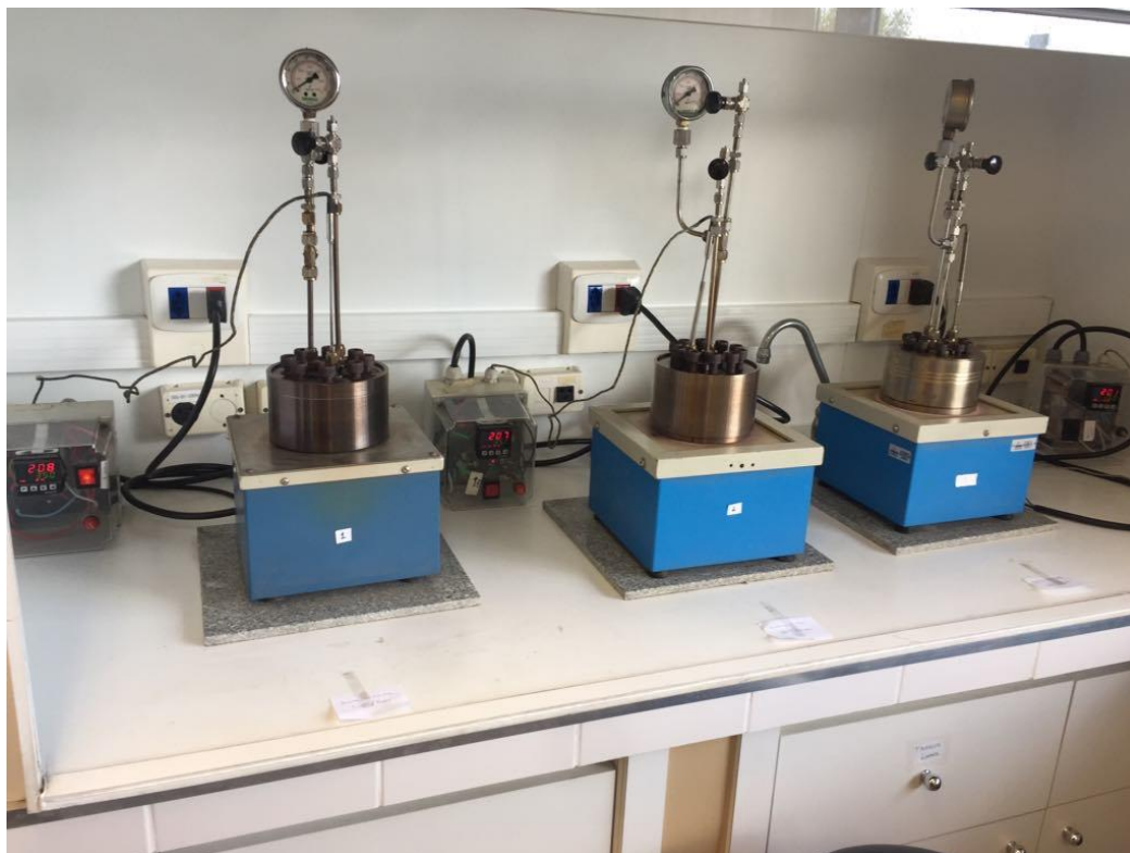
Figura 10. Reatores utilizados para realização dos experimentos de hidropirólise.
