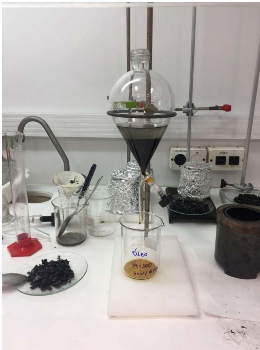
Figura 11. Separação do óleo e água, após o experimento de hidropirólise.
