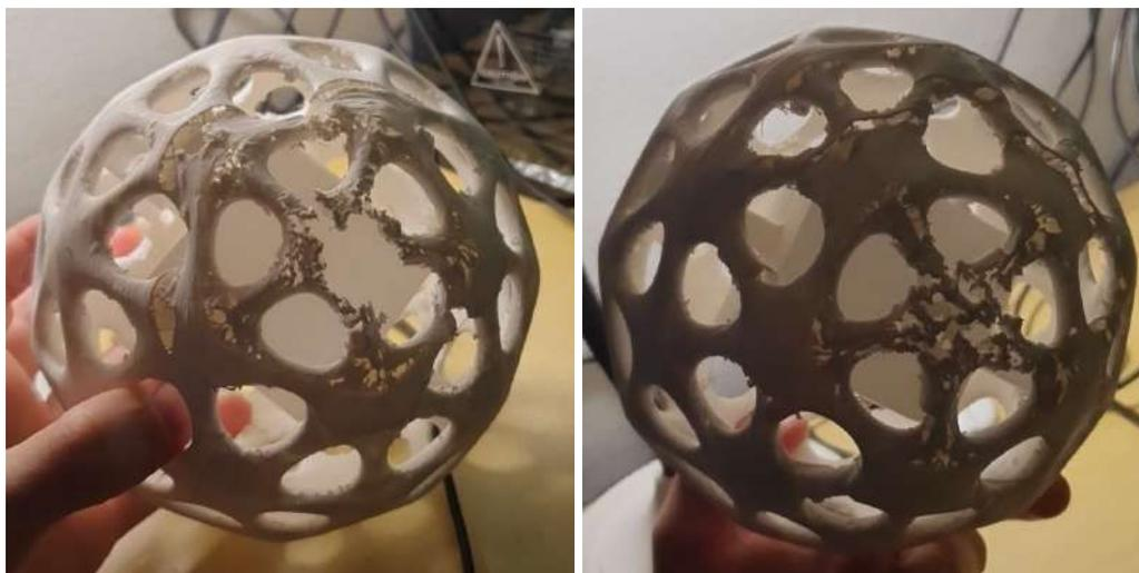
*Figura 15: erro na impressão dos pólos da esfera.*
