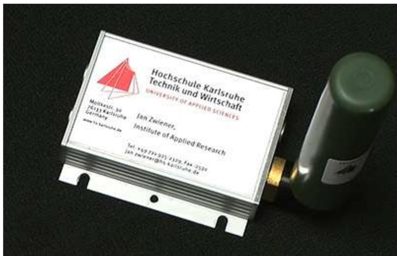
*Figura 2: controle do projeto de Jan Zwiener que inclui acelerômetro, giroscópio, magnetômetro, barômetro dentro da caixa metálica e antena GPS externa, disponível no site*
