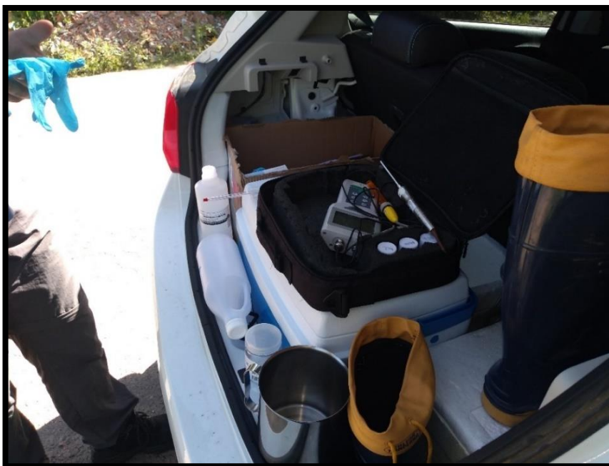
Figura 17 – Equipamentos e materiais de coleta de amostras de água.
