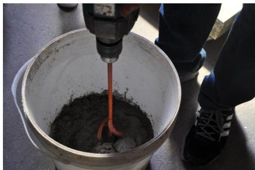
Figura 3: Procedimento de mistura utilizado para os chapiscos
