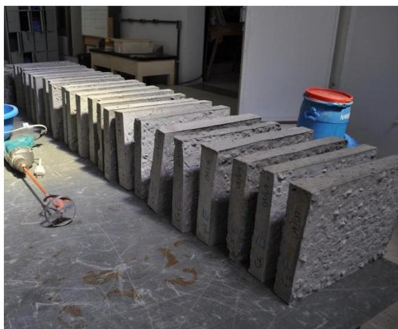
Figura 2: Placas de concreto utilizadas como substrato
