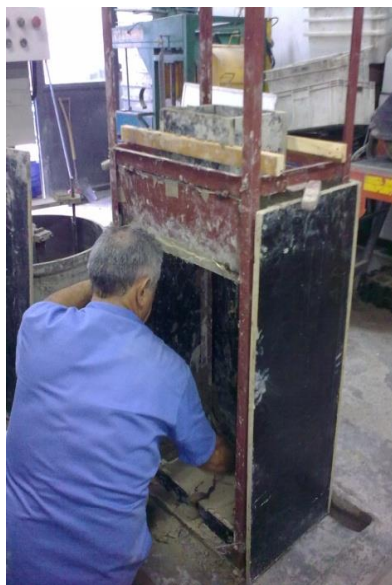
Figura 10: Aplicação da argamassa de revestimento através da caixa de queda (Fonte: Próprio autor).
