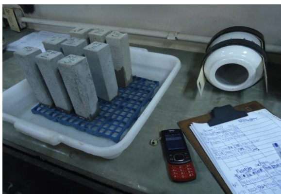
Figura 3: Execução do ensaio de absorção de água por capilaridade (Fonte: Próprio autor).
