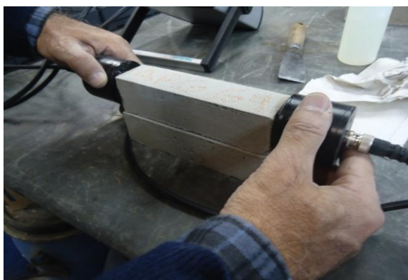
Figura 4: Execução do ensaio de ultra-som (Fonte: Próprio autor).
