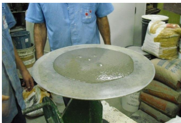
Figura 1: Execução do ensaio de consistência (Fonte: Próprio autor).
