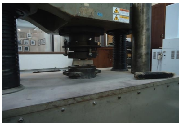
Figura 6: Execução do ensaio de tração na flexão e compressão das argamassas (Fonte: Próprio autor).
