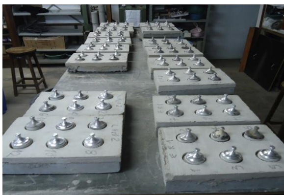
Figura 11: Placas prontas para o ensaio de aderência (Fonte: Próprio autor).
