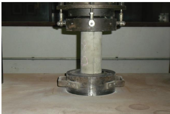
Figura 5: Execução do ensaio de compressão do corpo-de-prova do substrato (Fonte: Próprio autor).
