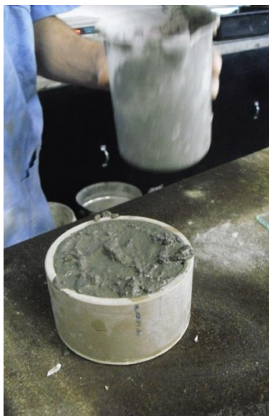
Figura 2: Execução do ensaio de densidade e teor de ar incorporado (Fonte: Próprio autor).
