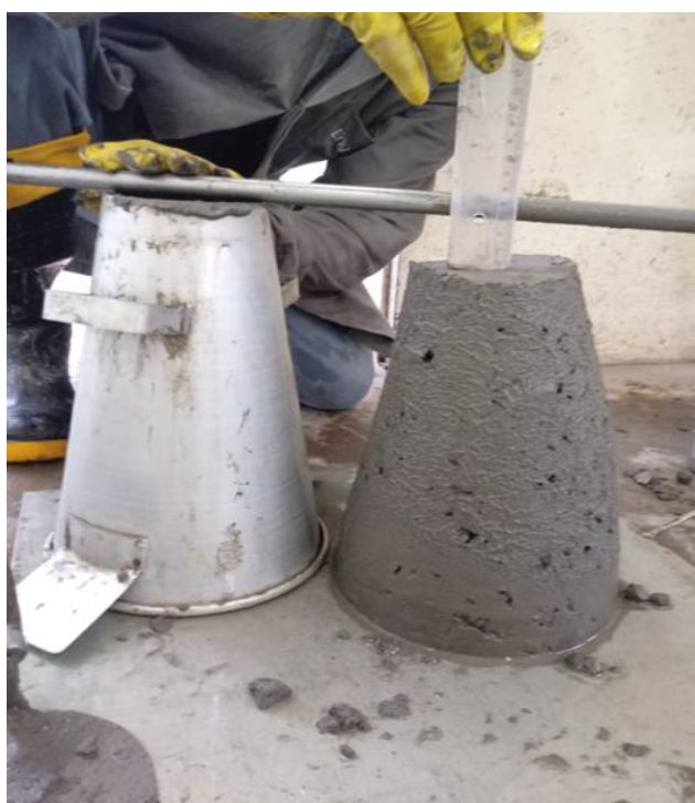
Figura 03- Ensaio de consistência pelo abatimento do tronco de cone do C6
