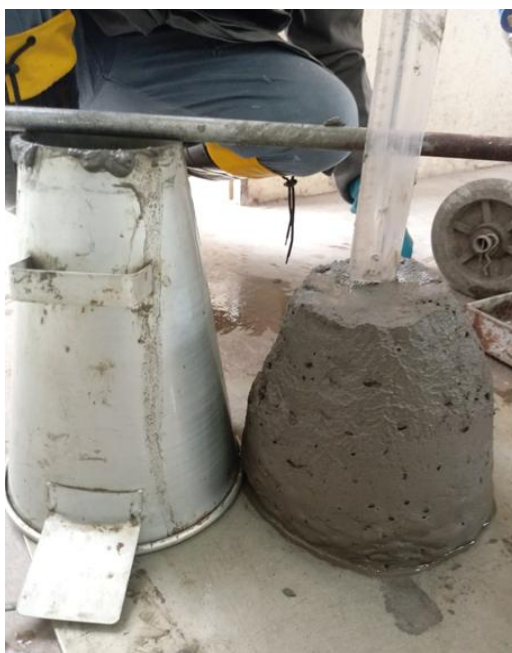
Figura 02- Ensaio de consistência pelo abatimento do tronco de cone do T.R.
