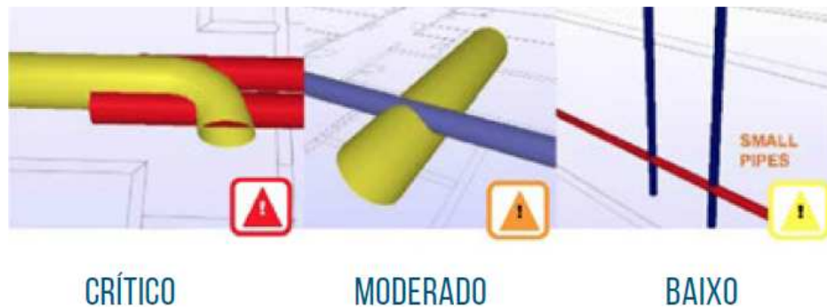
Figura 2: Clash detection com classificação das interferências
