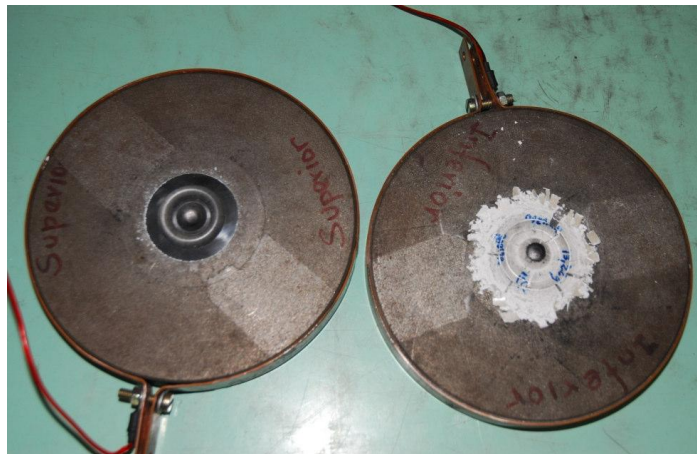
Figura 3.01 – Foto do conjunto de câmaras de Bridgman após a realização um processamento, em branco e no centro da câmara os resíduos da gaxeta contendo o material pressionado [54].
