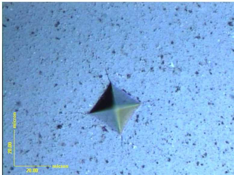
Figura 4.22 – Imagem típica de uma indentação de microdureza Vickers em amostras resultantes de processamentos a 2,5GPa/500°C/10min para amostra com Ítrio.
