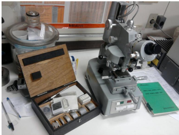
Figura 3.13 – Microdurômetro Shimadzu M e seus acessórios, disponíveis no LAPMA.
