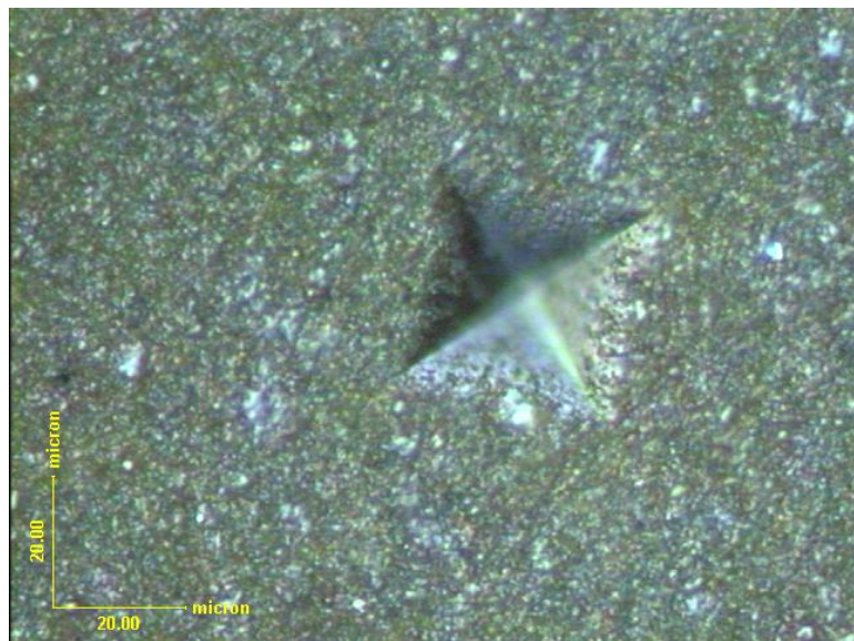
Figura 4.20 – Imagem típica de uma indentação de microdureza Vickers em amostras resultantes de processamentos a 2,5GPa/Amb/10min para o sistema com Ítrio.
