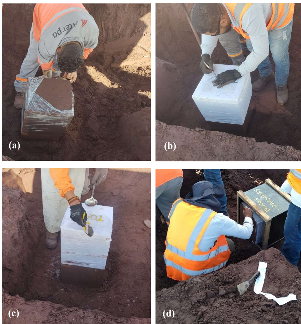
Figura 3.13 – Etapas da retirada das amostras indeformadas: (a) proteção do bloco com plástico filme; (b) proteção do bloco com tela; (c) camada de parafina; (d) extração do bloco
