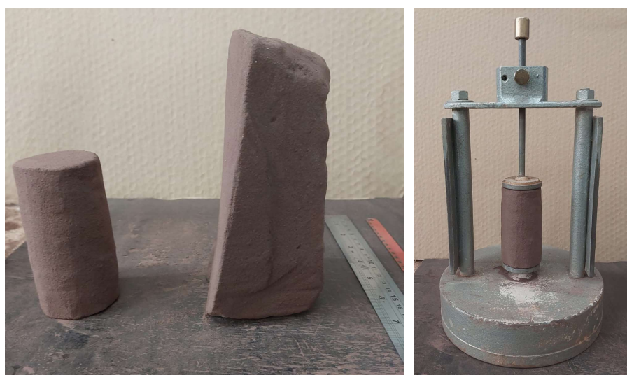
Figura 3.15 – Moldagem dos blocos indeformados
