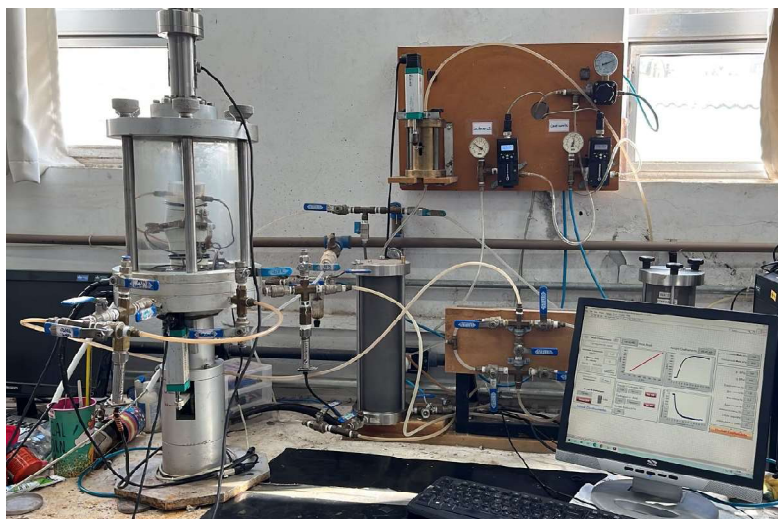
Figura 3.17 – Visão geral do Equipamento triaxial (Bishop-Wesleye)
