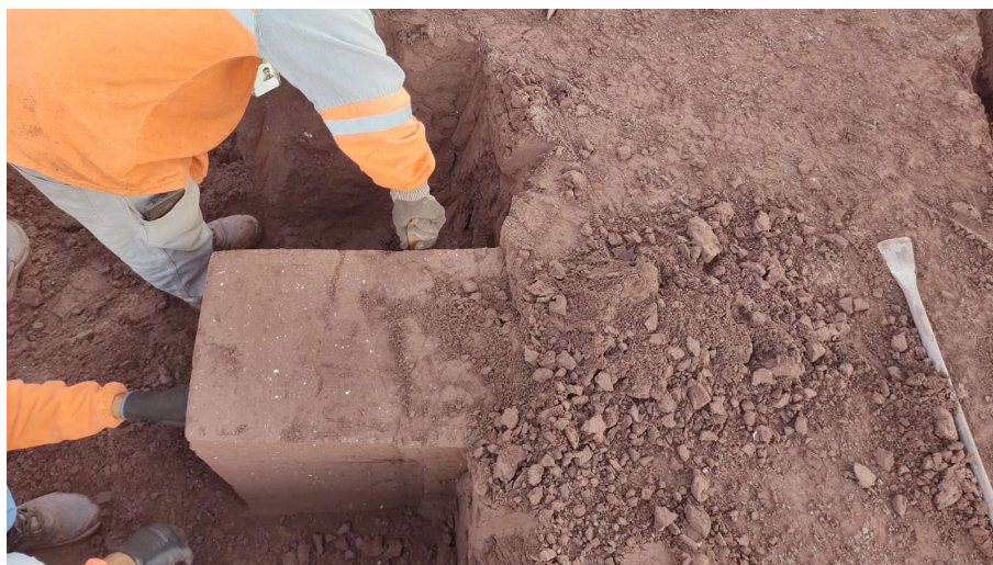
Figura 3.12 – Moldagem dos blocos indeformados
