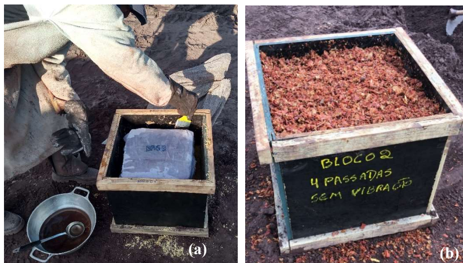
Figura 3.14 – Etapas do armazenamento das amostras indeformadas: (a) aplicação da tela e parafina; (b) preenchimento do espaço livre com serragem
