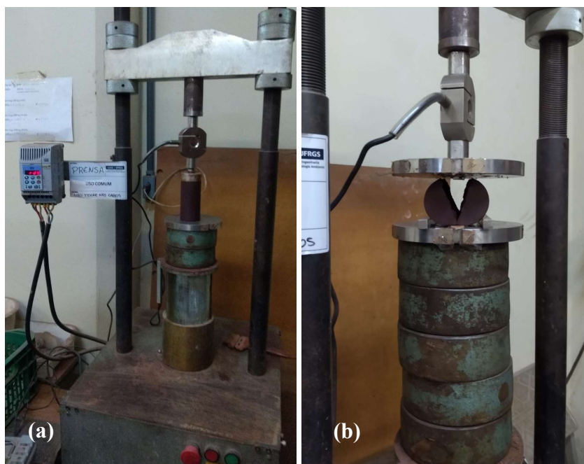
Figura 3.16 – Posicionamento do corpo de prova durante aplicação de carga: (a) RCS; (b) RTCD
