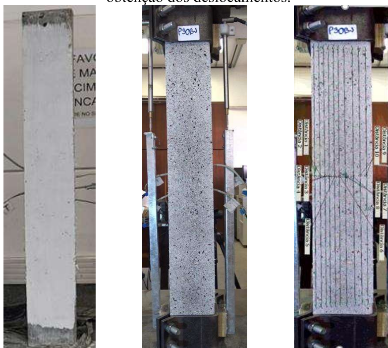
Figura 3 - Preparação das amostras para a metodologia DIC; (a) Passagem de duas demãos de tinta branca fosca; (b) Espraiamento com spray fosco preto; (c) Posicionamento das retas para obtenção dos deslocamentos.
