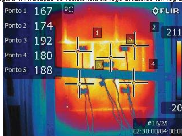
Figura 4: Avaliação da resistência ao fogo utilizando termografia.
