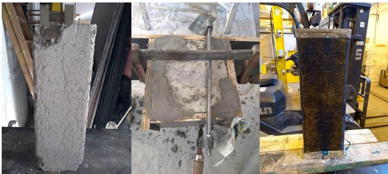
Figura 3: Execução do reforço (a) pilarete danificado após retirada do forno (b) aplicação da argamassa de reparo (c) aplicação da fibra de carbono.
