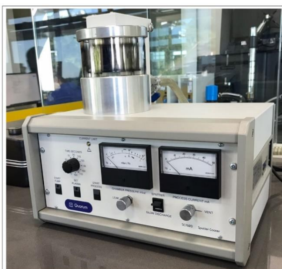
Figura 35 – SC7620 Mini Sputter Coater
