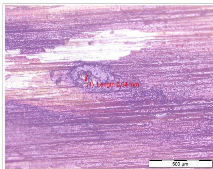
Figura 45 – Pite na face sem desbaste – lâmina conformada
