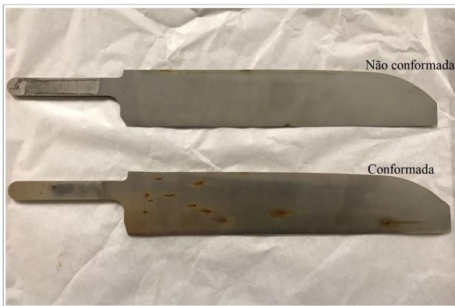
Figura 33 – Lâminas após ensaio de corrosão
