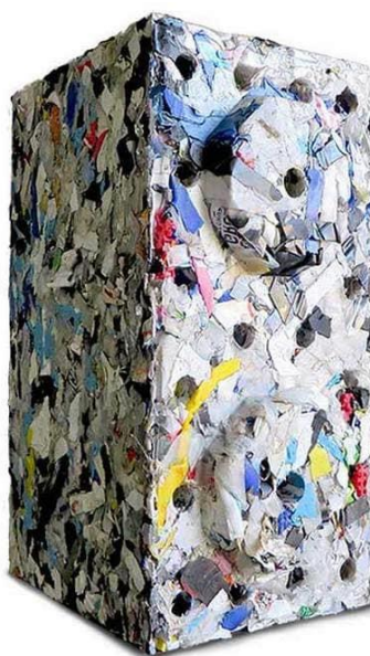
Figura 16 – Bloco produzido a partir de resíduos plásticos.
