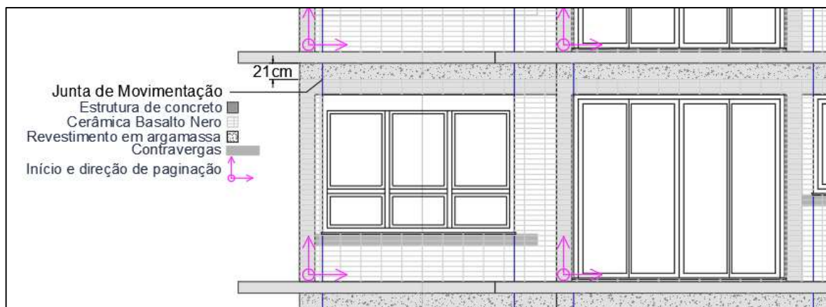
Figura 24 - Detalhe de revestimento cerâmico
