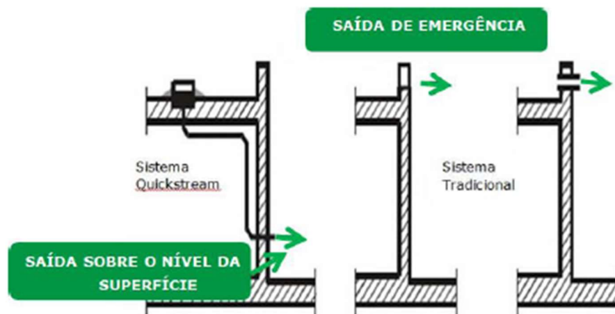
Figura 15 – Sistema alternativo de emergência.
