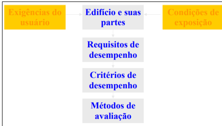
Figura 2 - Estrutura adotada na NBR15575
