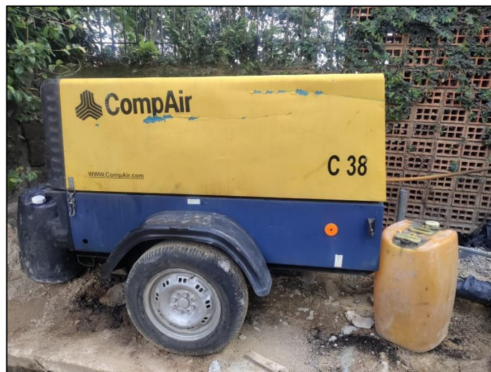
Figura 27 - Compressor a diesel utilizado para bombeamento
