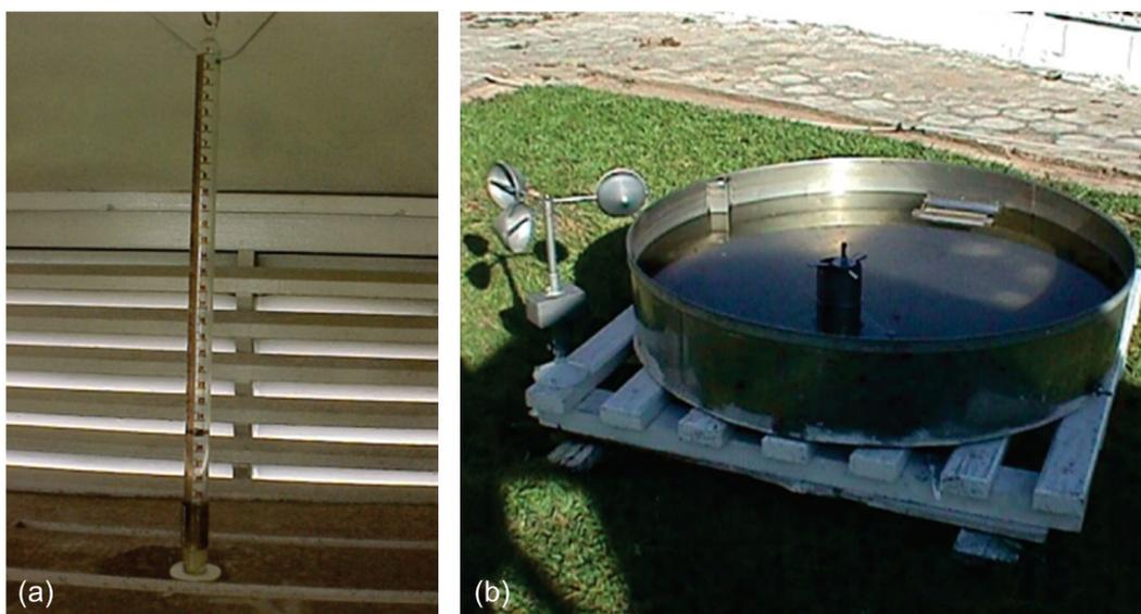
Figura 2.7. Equipamentos utilizados para a medição de evaporação da água: (a) evaporímetro de Piché, (b) tanque de evaporação classe A (fonte: INMET<sup>5</sup>).
