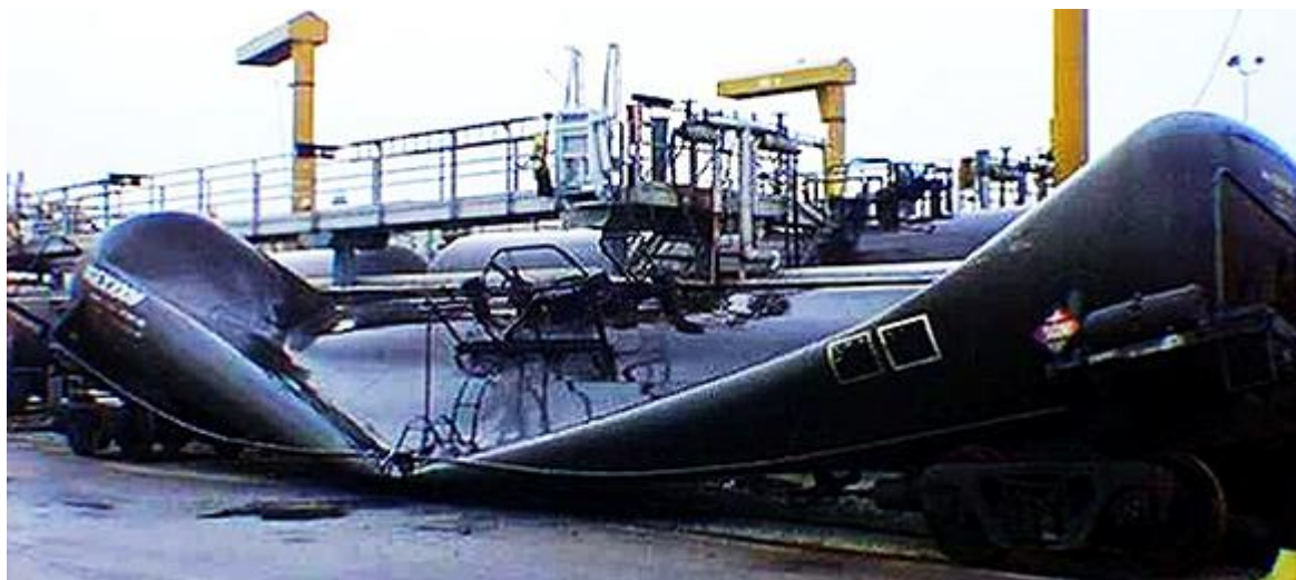
Figura 02 - Vagão-tanque esmagado pela pressão atmosférica. Fonte: Fundamentos de Física, volume 2: gravitação, ondas e termodinâmica (Halliday, Resnick & Walker, 2009)
