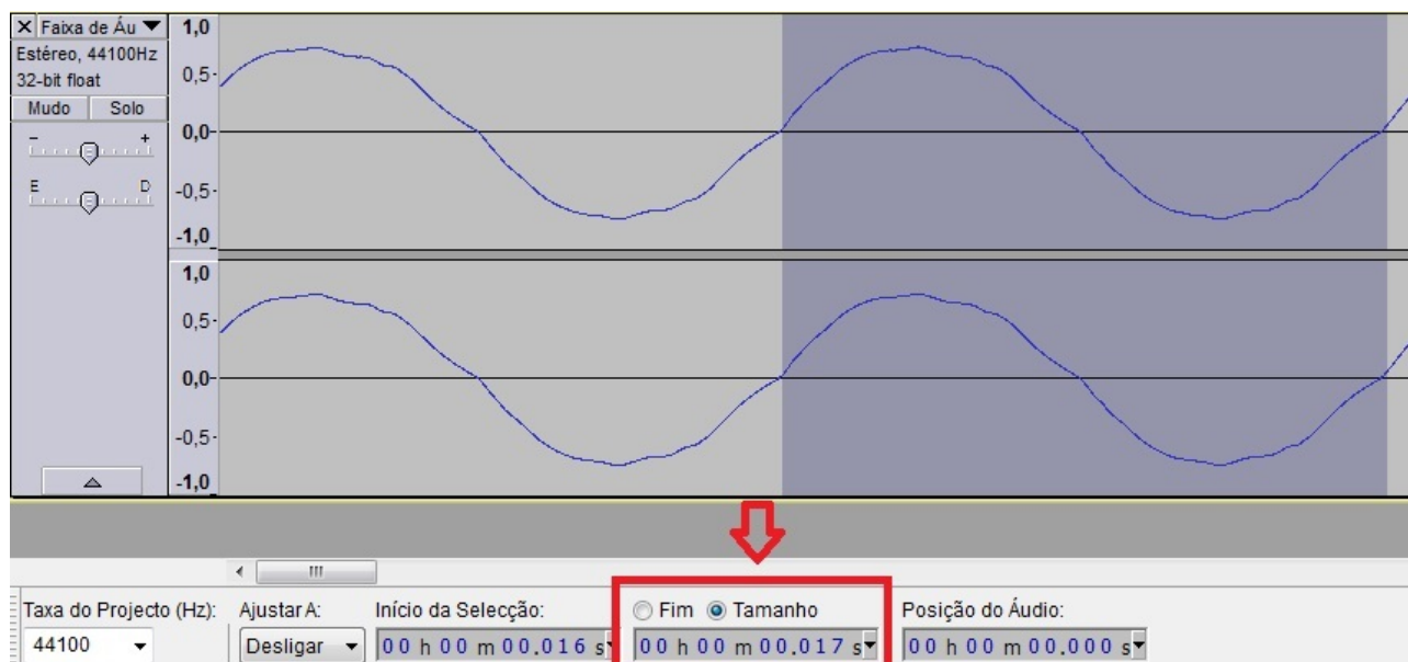
Figura 4 – Forma de onda da corrente elétrica de uma lâmpada incandescente de 100 W ligada a uma tomada elétrica de 220 V e 60 Hz. Observe que o valor do tamanho da seleção na parte do desenho que foi marcada com um quadro é de 17 ms, próximo dos 16,67 ms esperados.
