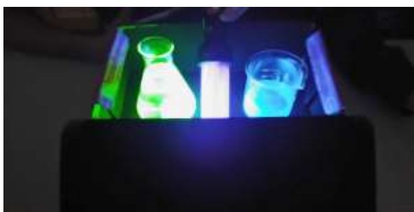
Figura 3- Fluorescência da tinta do marca texto verde e do sabão em pó diluído em água
