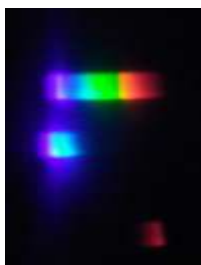
Figura 04 – Espectros de três LEDs diferentes (branco, azul e vermelho), decomposto pela grade de difração.
