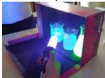
Figura 2- experimento sendo realizado, visualização da fluorescência utilizando a lâmpada UV.
