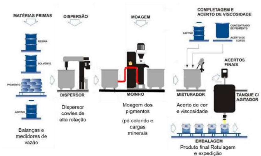
Figura 1: Etapas do processo de fabricação de uma tinta
