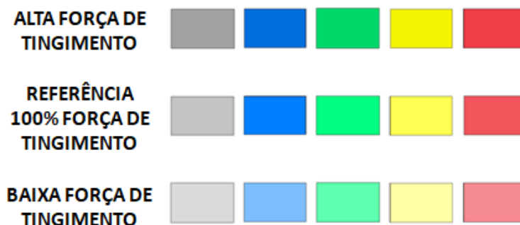
Figura 2: Exemplo de força de tingimento alta e baixa
