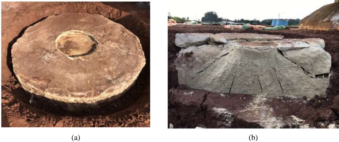
Figura 2.51: Camada melhorada de diâmetro de 900mm e espessura de 300mm após ensaio de campo (a) vista superior (b) corte lateral com visualização das fissuras (CONSOLI et al., 2020)
