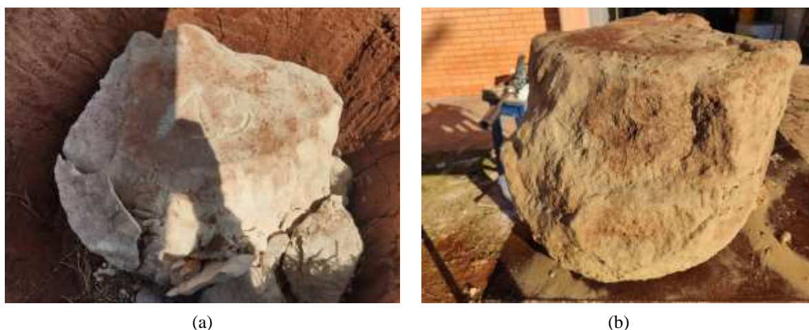
Figura 5.2: Ruptura por puncionamento no solo residual – camada Dr450Hr300 e=D/4 \eta/C_{iv} = 26 (a) após ruptura (b) após exumação – plano de cisalhamento que não atinge a base da camada
