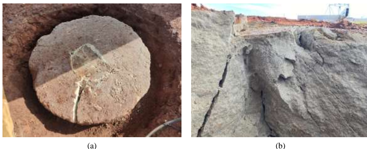
Figura 5.5: Ruptura generalizada – camada Dr900Hr300 e=D/4 \eta/C_{iv} = 17 (a) após ruptura (b) durante exumação
