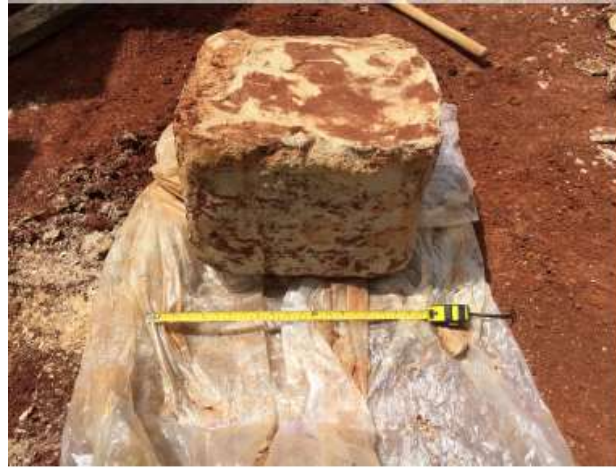
Figura 2.45: Camada melhorada de dimensões 45 x 45 x 30 cm removida do campo após ensaio (CONSOLI et al., 2019)
