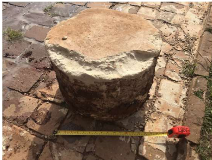
Figura 2.50: Camada melhorada de diâmetro de 450mm e espessura de 300mm removida do campo após ensaio (CONSOLI et al., 2020)
