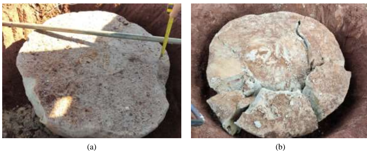
Figura 4.73: Exemplos de camadas nas quais houve inclinação da placa de aço (a) Dr750Hr450 (17) e=3,75 (b) Dr600Hr300 (17) e=3,75
