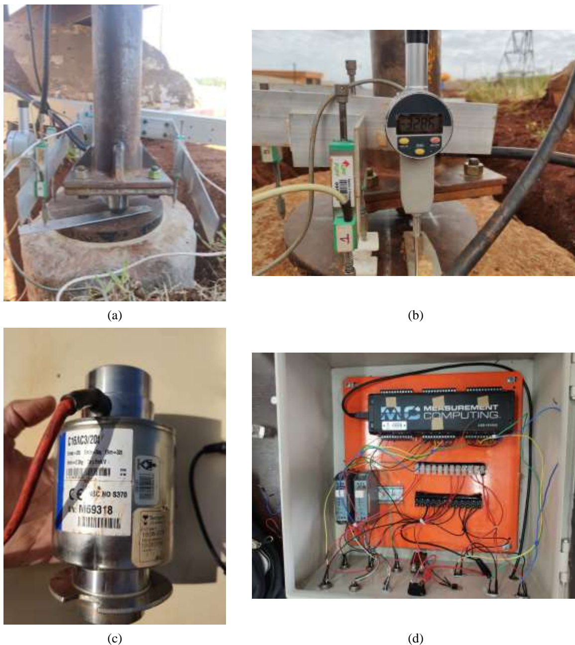
Figura 3.15: Sistemas de (a) aplicação de carga (b) medição de deslocamentos (c) célula de carga e (d) aquisição de dados
