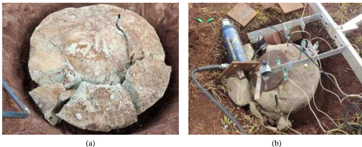
Figura 4.13: Situação observada após a ruptura das camadas (a) camada de D_r = 600\text{mm} H_r = 300\text{mm} e e=D/8 ( \eta/C_{iv} = 17 ) (b) queda da instrumentação
