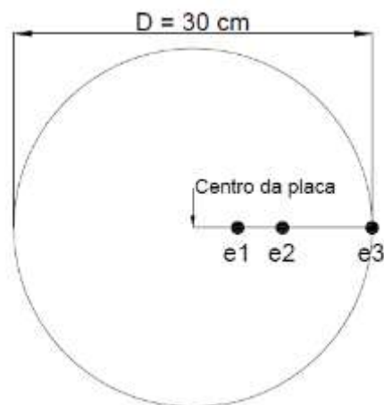
Figura 3.4: Esquema de aplicação de carga
