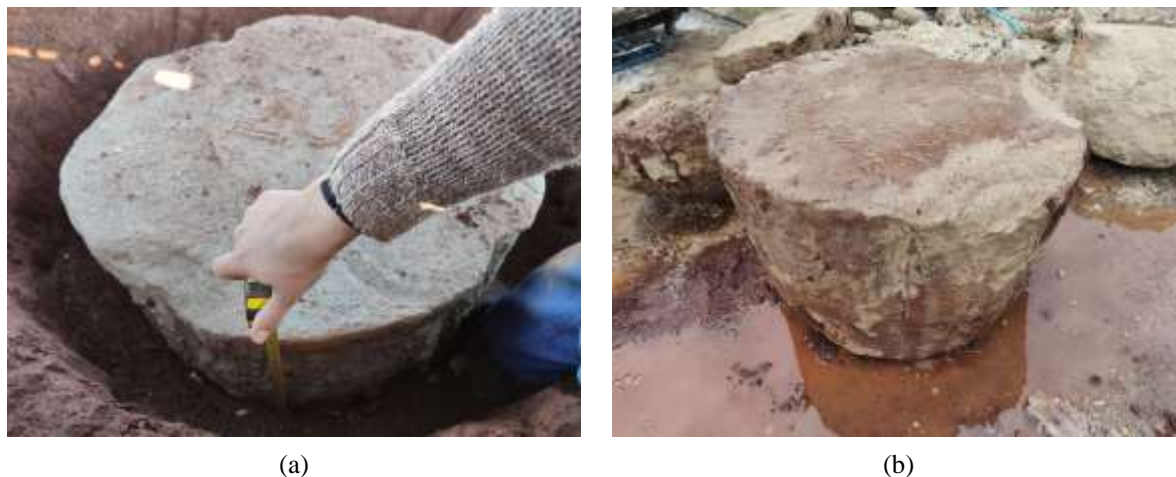
Figura 5.4: Ruptura por punção no solo residual – camada D_r750H_r450 e=D/8 \eta/C_{iv} = 17 (a) após ruptura (b) após exumação – camada intacta
