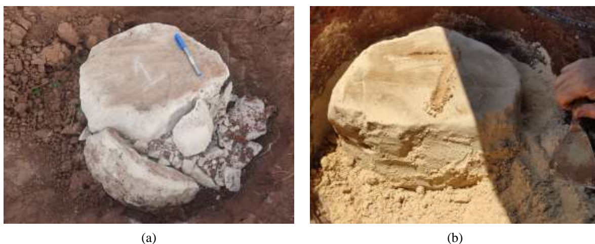
Figura 5.1: Ruptura por cisalhamento – fissura que surge do topo em direção à base (a) Dr375Hr150 e=D/4 \eta/C_{iv} = 17 (b) Dr450Hr150 e=D/4 \eta/C_{iv} = 26
