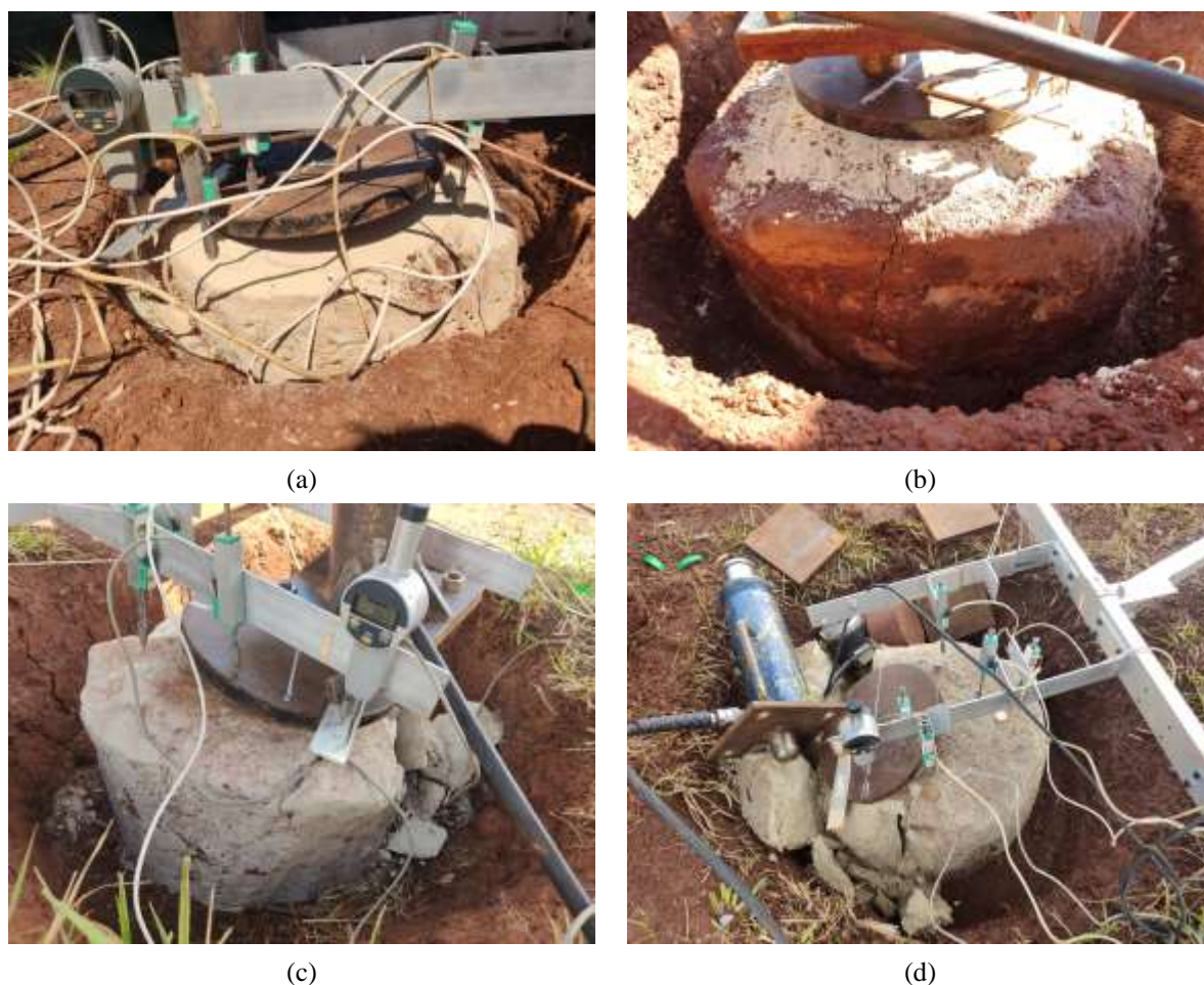
Figura 4.71: Ilustração da forma de ocorrência do giro da placa de aço
