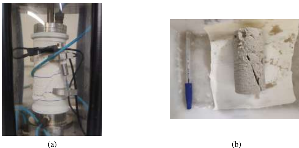
Figura 4.115: Amostra submetida ao ensaio triaxial (a) dentro da câmara e (b) superfície de ruptura apresentada
