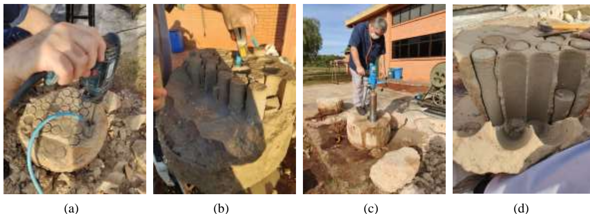
Figura 3.18: Extração de amostras das camadas cimentadas (a) d=50\text{mm} (b) d=50\text{mm} (c) d=100\text{mm} (d) d=100\text{mm}
