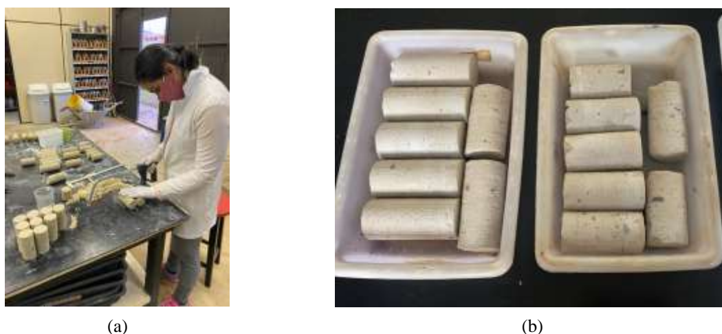
Figura 3.19: Ajuste das dimensões das amostras extraídas (a) serra manual (b) amostras prontas
