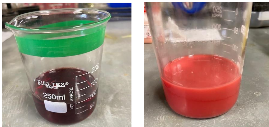
Figura 5 – Amostras de óleo lubrificante antes e depois da adição das nanopartículas de óxido de cério padrão
