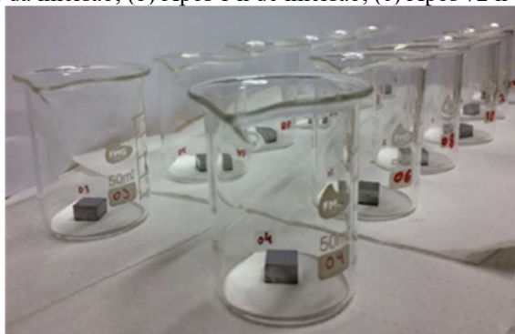
Figura 16 - Aspecto visual da formação de produto de corrosão em relação ao tempo de imersão em S_2O_3^{2-} : (a) Antes da imersão; (b) Após 1 h de imersão; (c) Após 72 h de imersão.
