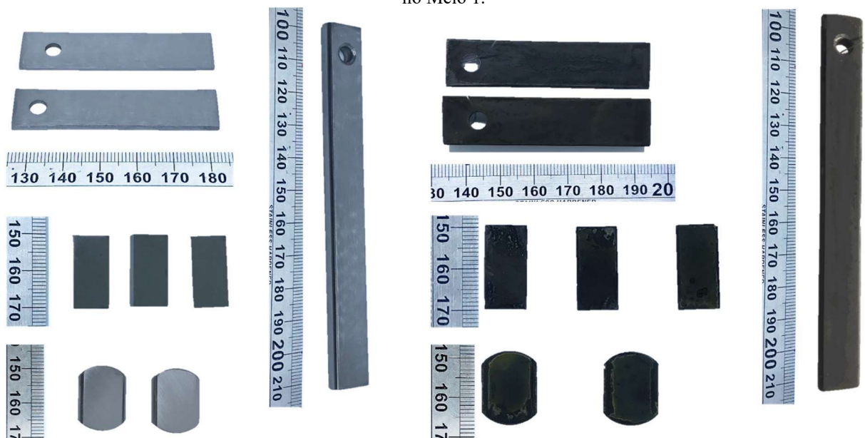
Figura 31. Exemplo do aspecto visual das amostras antes (à esquerda) e após (à direita) dos ensaios de imersão no Meio 1.
