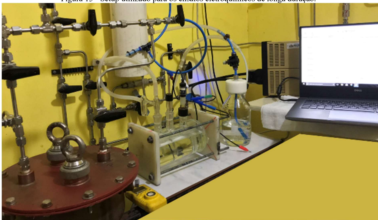
Figura 15 - Setup utilizado para os ensaios eletroquímicos de longa duração.
