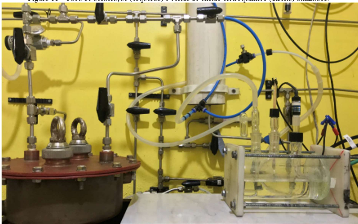
Figura 11 - Cuba de desaeração (esquerda) e célula de ensaio eletroquímico (direita) utilizados.
