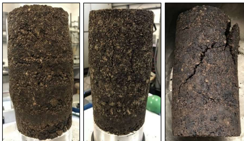
Figura 47 - Corpos de prova rompidos no ensaio triaxial de carregamento monotônico: rupturas por embarrilamento (à esquerda e ao centro) e um possível plano de ruptura após a remoção do corpo de prova da estufa.
