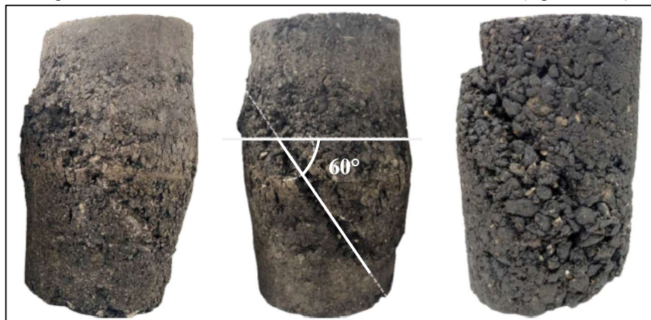
Figura 14 - Amostras submetidas ao ensaio triaxial monotônico (ruptura à 60°).
