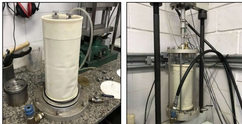
Figura 31 - Colocação da membrana de borracha (à esquerda) e ensaio triaxial de módulo de resiliência em andamento (à direita).
