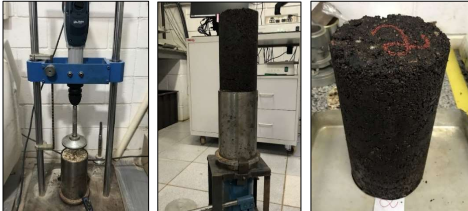
Figura 30 - Compactação no molde de parede contínua (à esquerda), processo de extrusão (ao centro) e aparência de um corpo de prova 150x300mm (à direita).
