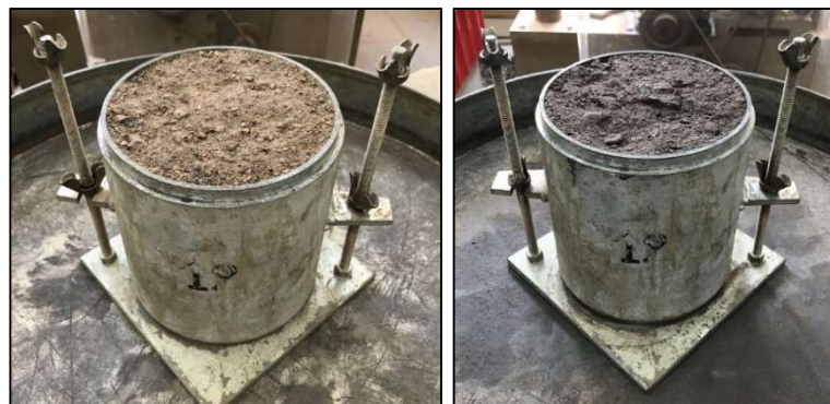
Figura 24 - Ramo seco (à esquerda) e úmido (à direita) da curva de compactação.
