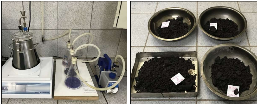
Figura 33 - Equipamento (à esquerda) e amostras (à direita) empregadas na execução do ensaio Rice.
