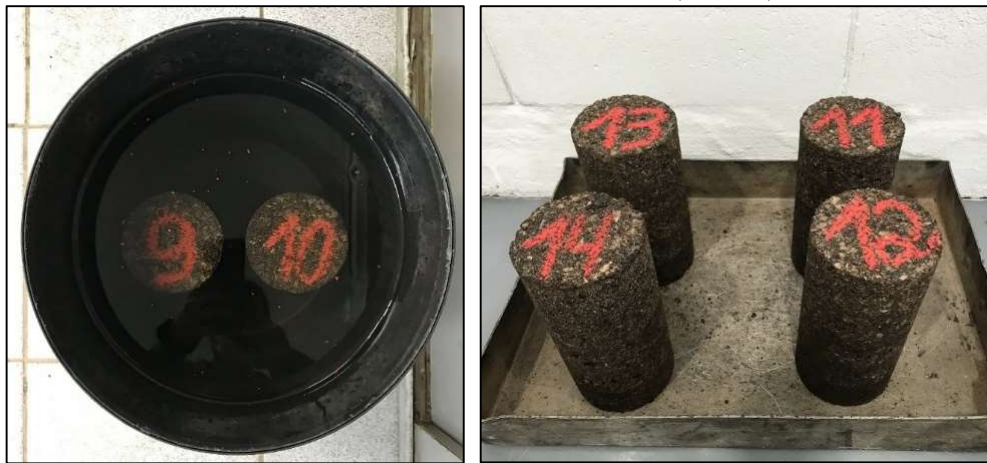
Figura 28 - Corpos de prova 100x200mm em imersão (à esquerda) e logo após a conclusão da cura controlada sem imersão (à direita).
