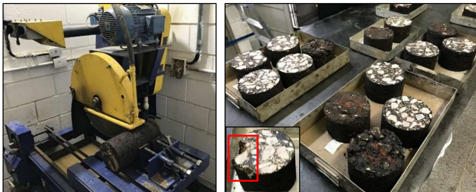
Figura 32 - Serra circular (à esquerda) e aspecto dos corpos de prova após o corte ser concluído (à direita).
