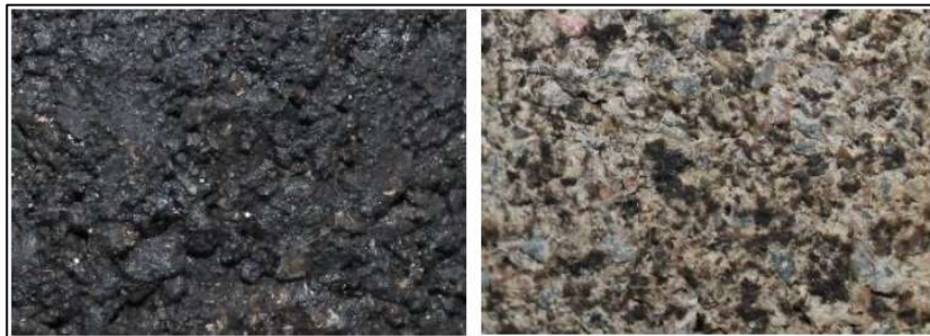
Figura 3 - Amostra estabilizada com emulsão (à esquerda) e espuma (à direita).
