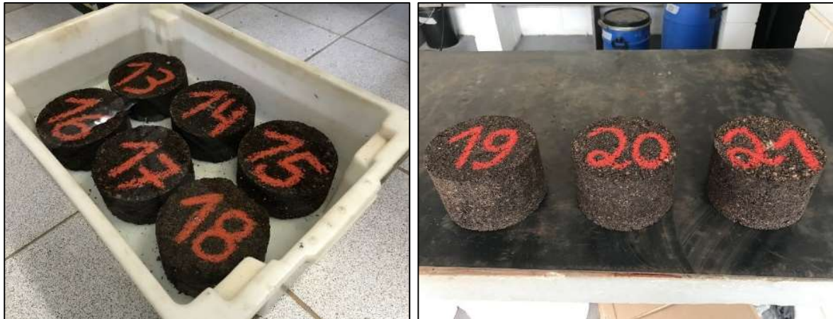
Figura 26 - Corpos de prova 150x95mm em imersão (à esquerda) e logo após concluída a cura controlada sem imersão (à direita).
