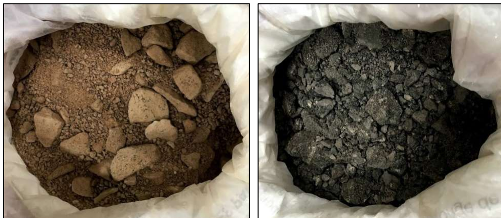
Figura 22 - Detalhe das amostras de BGS (à esquerda) e RAP (à direita).
