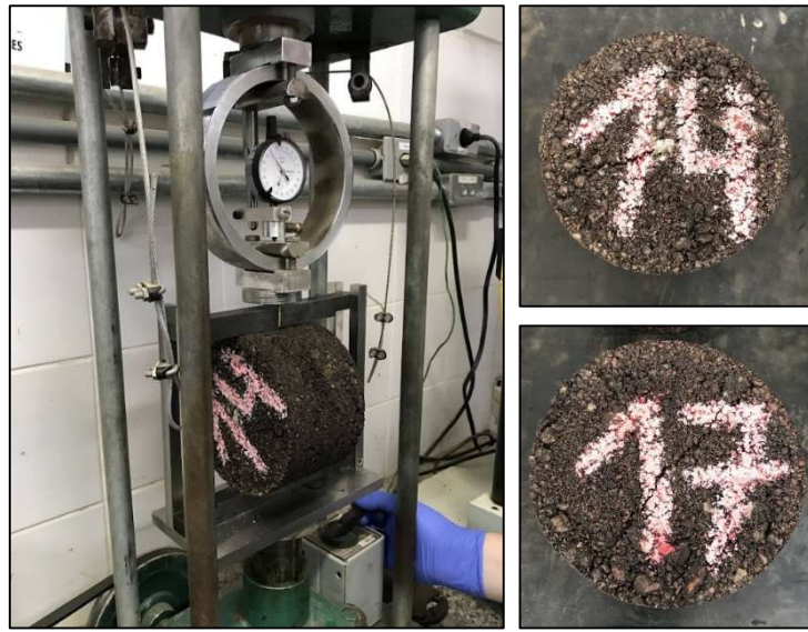
Figura 27 - Prensa utilizada nos ensaios ITS (à esquerda) e corpos de prova rompidos (à direita).
