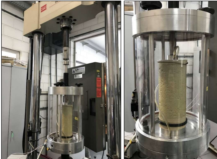
Figura 29 - Equipamento MTS (à esquerda) e detalhe da \sigma_3 sendo aplicada em um corpo de prova (à direita).
