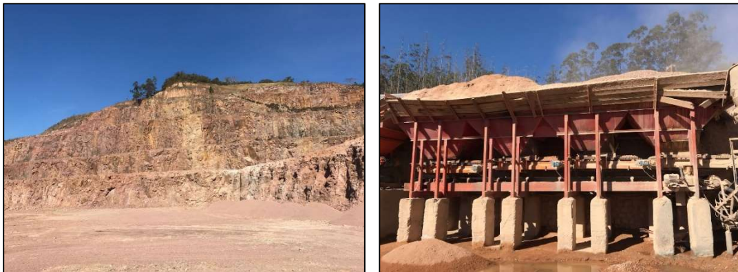
Figura 20 - Maciço rochoso granítico (à esquerda) e usina utilizada na produção da BGS (à direita).
