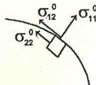
Fig. 1. Diagrama das tensões em um elemento infinitesimal na face da estrutura
