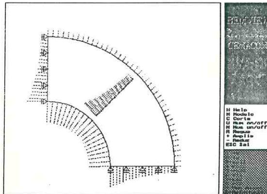
Fig. 3: Tubo sob pressão interna, von Mises
