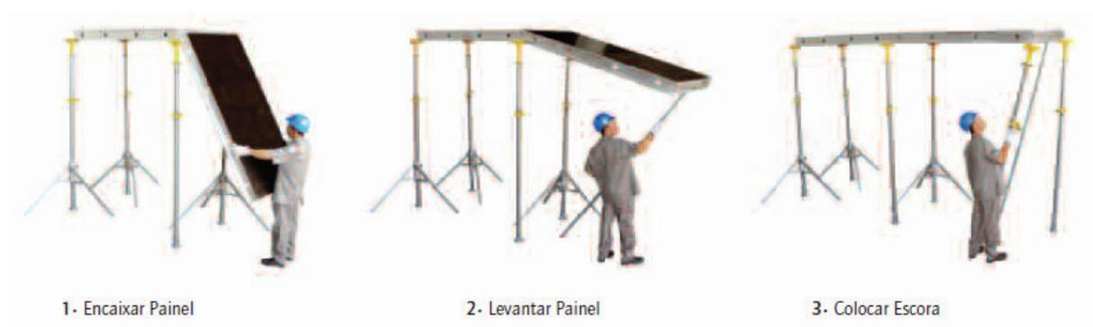
Figura 17: sequência de montagem do sistema para lajes lisas e nervuradas com EPS (SH FÔRMAS, ANDAIMES E ESCORAMENTOS LTDA., 2009, p. 2)
