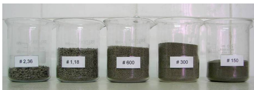
Figura 20: frações granulométricas do agregado para ensaio
