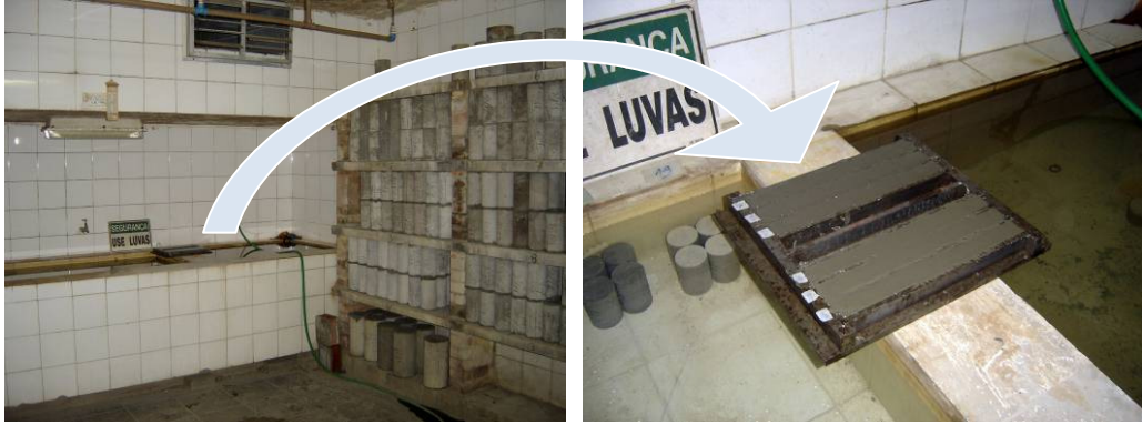
Figura 24: acondicionamento das fôrmas com os corpos-de-prova em câmara úmida
