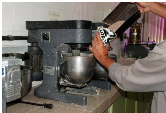
Figura 22: colocação do agregado na argamassadeira
