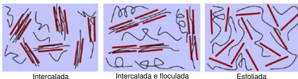
Figura 12: Tipos de morfologias observadas em NCPA com nanoargilas [35].
