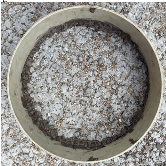
Figura 6 – Selagem interna com massa de calafetar no anel de infiltração
