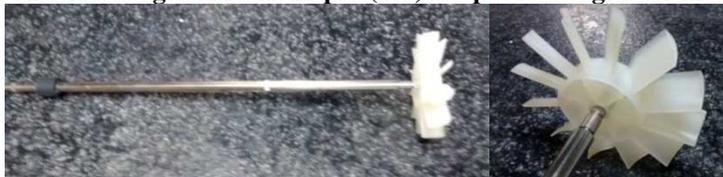
A solução polissacarídica foi injetada manualmente a uma vazão média de 4,70 mL/s, a cerca de 20 cm em relação às pás do agitador mecânico (Figura 24). Conforme foi sendo injetada à solução alcoólica, as fibras formaram-se por desidratação e estiramento.
