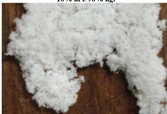
Figura 38. Imagem fotográfica de algomerado de partículas bem compactado obtido por *jet-spinning* da solução(aq) a 2%, 80% ag, 20% al.
