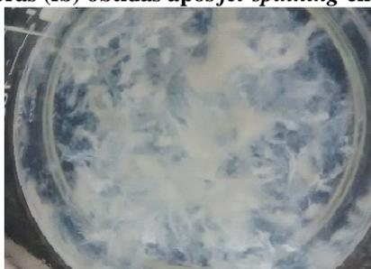
Após a reticulação, as fibras (fb) foram novamente coletadas, a fim de que todo o líquido escorre-se, para serem moldadas (prensadas entre dois vidros) na forma de “tecido” (tec.) (Figura 26), a uma espessura média de 1,66cm +/- 0,35cm.
