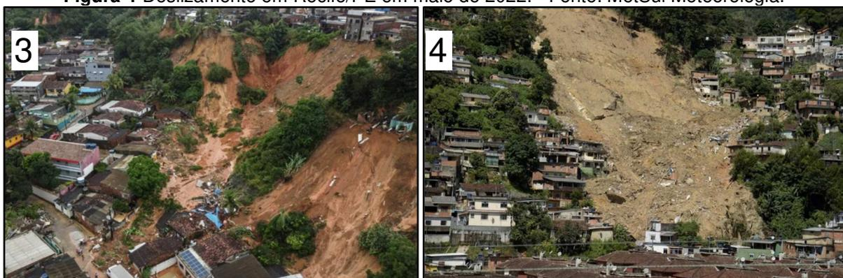
Os deslizamentos se diferenciam basicamente pela sua forma e material deslocado, podendo ser translacional ou rotacional, de terra ou de rocha. O deslizamento translacional ocorre em solos pouco espessos, que apresentam um plano de fraqueza definido, em relação à base rochosa. O deslizamento rotacional
