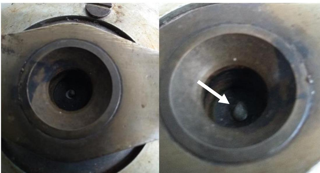
FIGURA 5. Local de inserção do pecíolo da folha (esquerda) em uma câmara de Scholander, mostrando a seiva do xilema sendo exsudada após a aplicação de pressão (seta à direita). Fonte: TRAPP, K. C., 2019.
