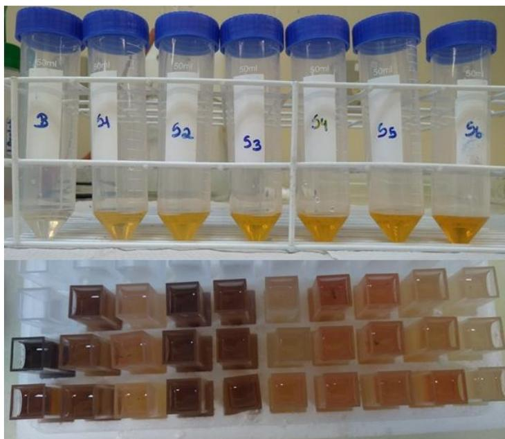
FIGURA 53. Amostras preparadas a partir do sistema radicular de *Hippeastrum reticulatum* var. *striatifolium* cultivada em diferentes frequências de irrigação para análise de absorvância de carboidratos. Em tubos Falcon preparação da curva padrão de glicose.
