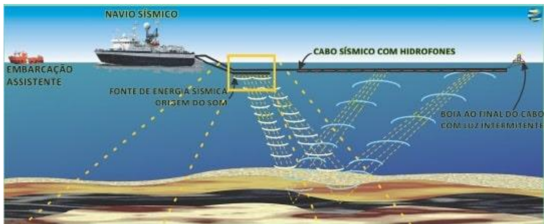
Figure 2: Figura ilustrativa esquematizando a aquisição sísmica. (fonte: web)
