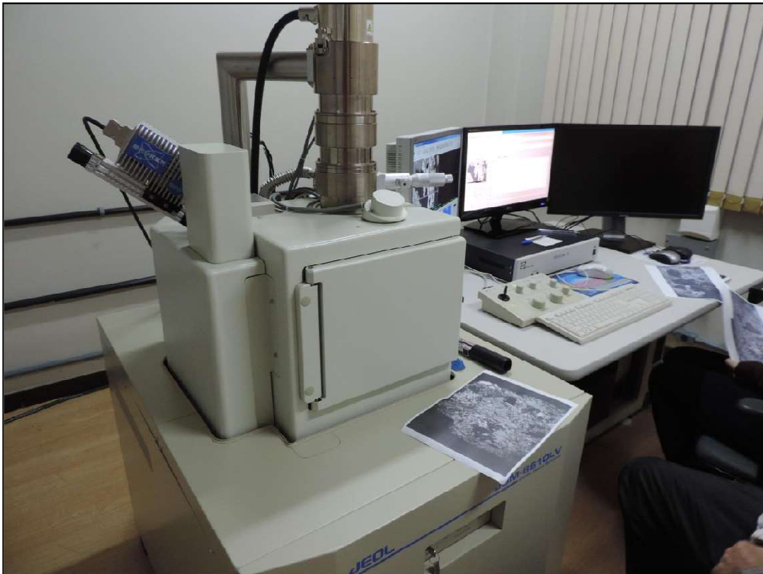
Figura 1-Fotografia do MEV com o tubo de elétrons, a câmara de amostras, o equipamento de catadoluminescência a esquerda com selo azul, e o display de navegação e analítico.
