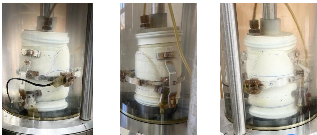
Figura 69 – Evidência do plano de cisalhamento das amostras CP20P – 2d (a) 40 kPa (b) 80kPa (c) 160 kPa.
