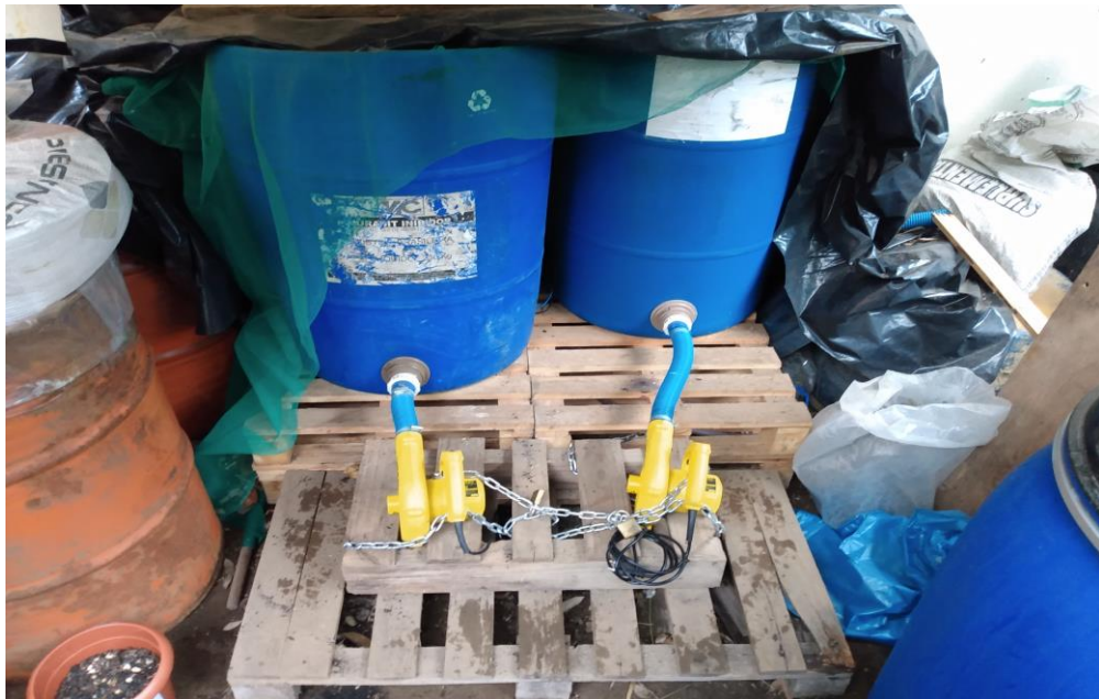
Figura 25 – Bombona adaptada para testes em escala reduzida do sistema de compostagem por aeração forçada
