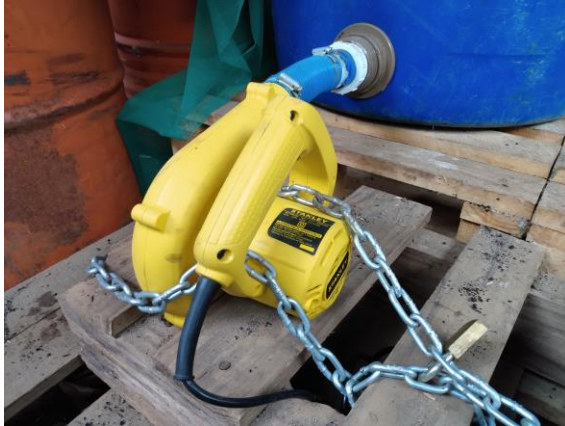
Figura 28 – Modelo de soprador adotado no protótipo de compostagem por aeração forçada e dados de vazão de ar possíveis de ser aplicado com o equipamento
