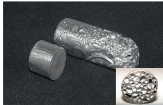
Fig. 8. Comparação entre amostra expandida e compactada.
