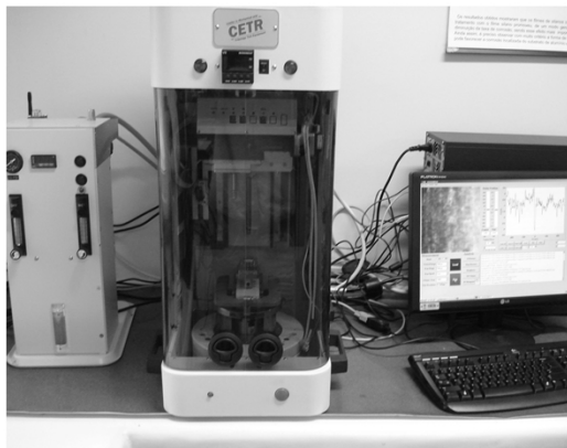
Figura 1. Tribómetro usado en los ensayos de desgaste
