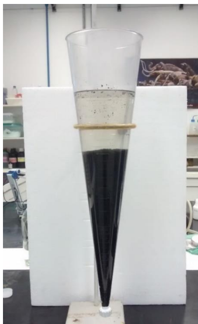
Figura 20 – Volume de lodo sedimentado gerado por litro de efluente tratado no cone de Imhoff.
