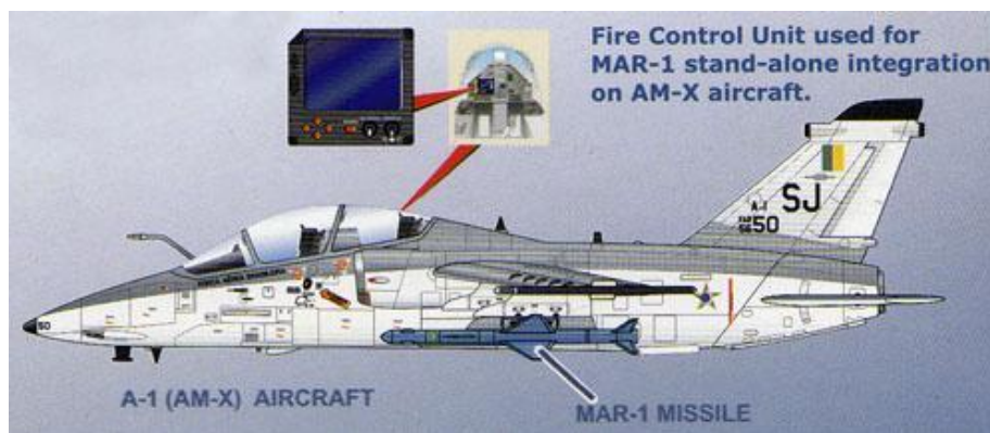
Figura 6 - Ilustração da unidade de integração do míssil MAR-1 ao caça AM-X
