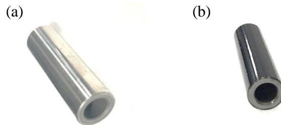
Figura 7: Representação dos pinos de aço 100Cr6 (a) sem revestimento e (b) com revestimento DLC.
