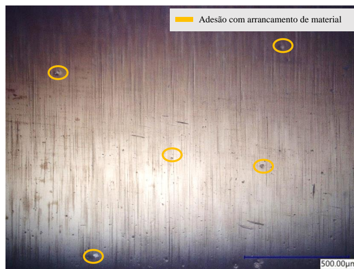
Figura 16: Microscopia óptica do pino do pistão revestido com DLC na região de contato com o pistão (ampliação de 200×).
